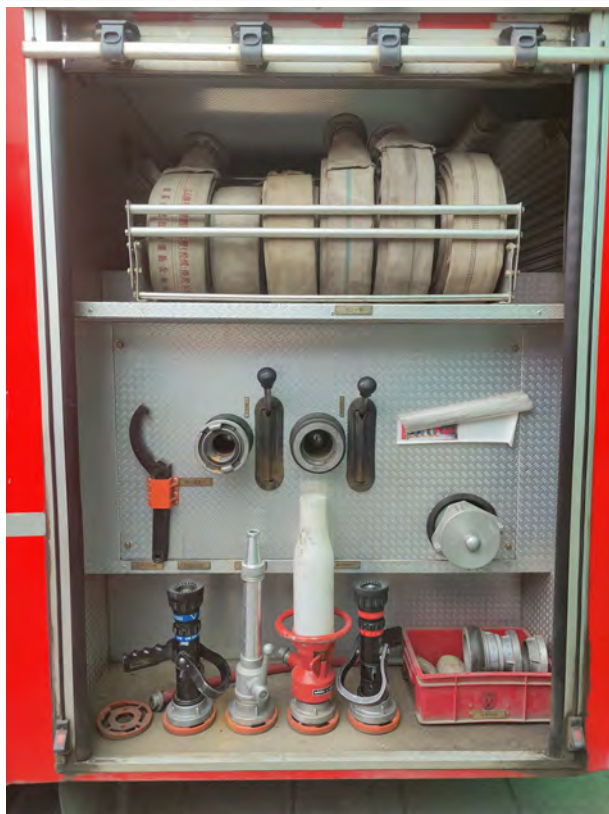
消防水带、水枪（保卫部）
